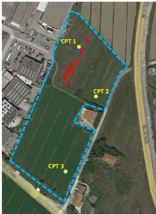
**Fig.11** Ubicazione prove Cpt e MASW eseguite all'interno del comparto 2 (estratta da relazione geologica di supporto alla Variante Urbanistica – Ing Solution 2023)
