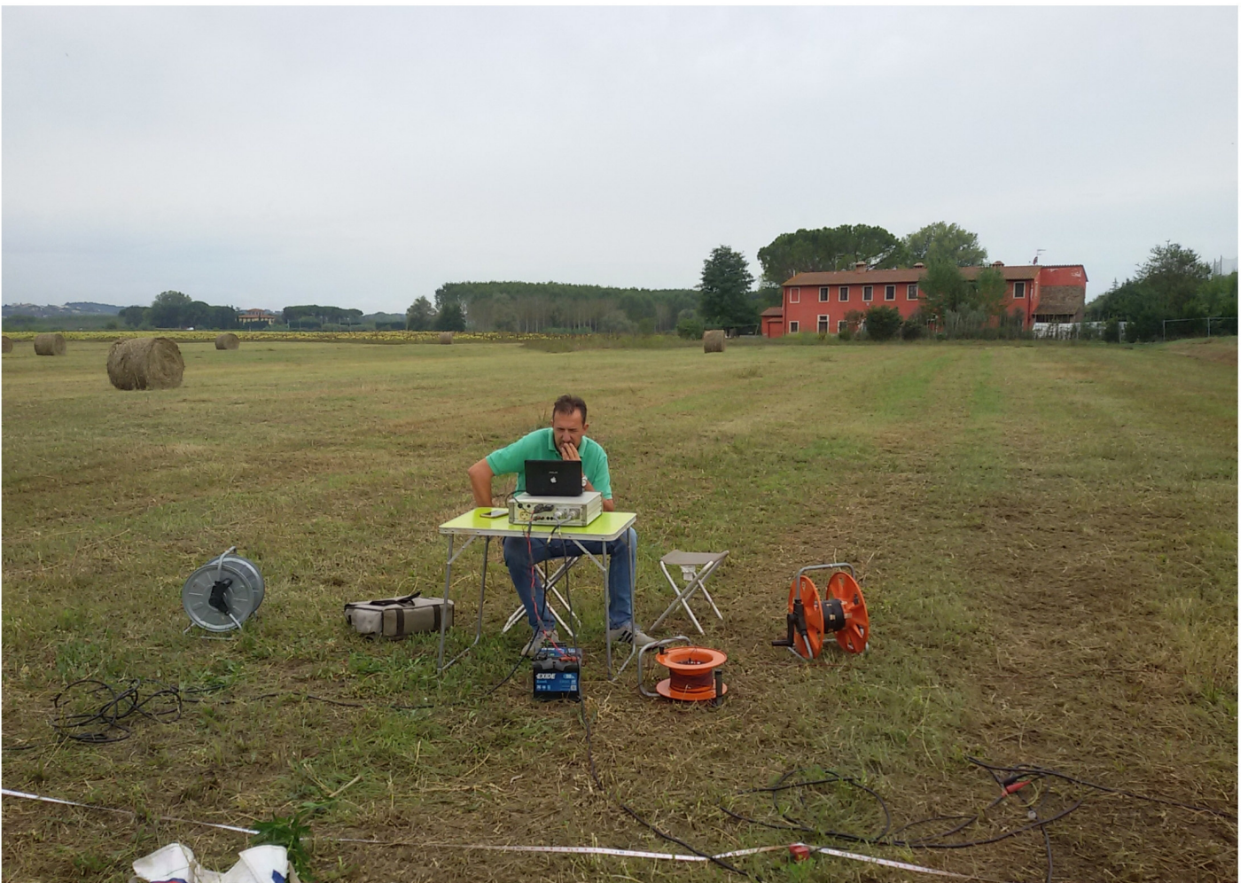
linea geosismica a rifrazione in onde S loc. Forcoli - documentazione fotografica
