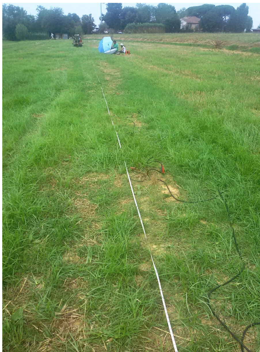
linea geosismica a rifrazione in onde S loc. I Fabbri - documentazione fotografica
